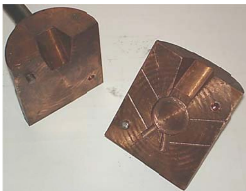
Рис. 2. Общий вид медного разъемного кокиля для получения образцов Ø35 мм и толщиной 6 мм
